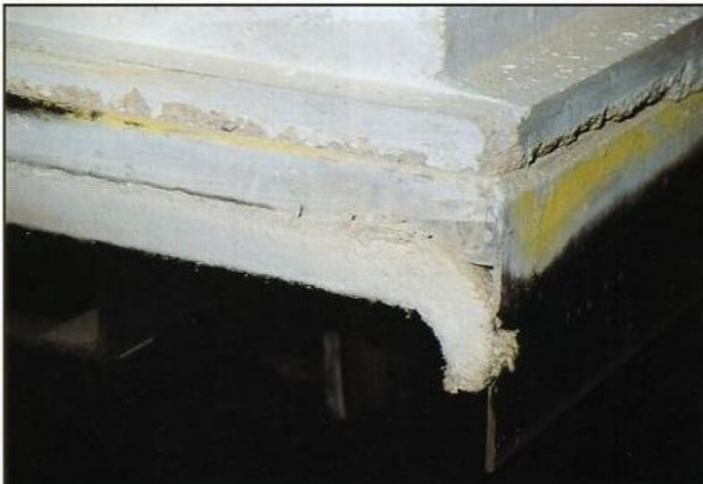
7 Guarnizione in corda di amianto sull'estremità dei carrelli da forno per la cottura di laterizi
