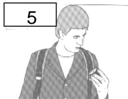
**Controllo condensato della pressione della bombola, della tenuta delle tubazioni e del funzionamento del fischio di allarme.**
