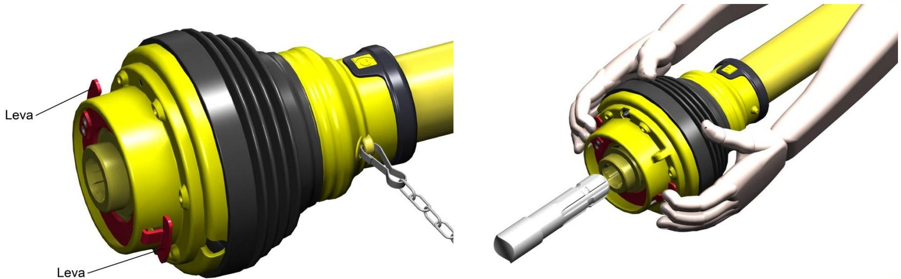
Nelle forcelle pull collar le operazioni di innesto/disinnesto sono nettamente semplificate è sufficiente tirare indietro le 2 leve rosse per aprire il sistema di blocco e consentire l'inserimento o la fuoriuscita della PTO.
