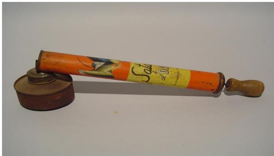
Veniva fornito con l'apposita pompetta: un tubo metallico lungo una ventina di centimetri, terminava con una manopola di legno che muoveva uno stantuffo situato all'interno. Tirando indietro la manopola lo stantuffo aspirava l'aria e spingendola questa veniva soffiata all'interno di un cilindretto che conteneva il Flit che fuoriusciva vaporizzato.
