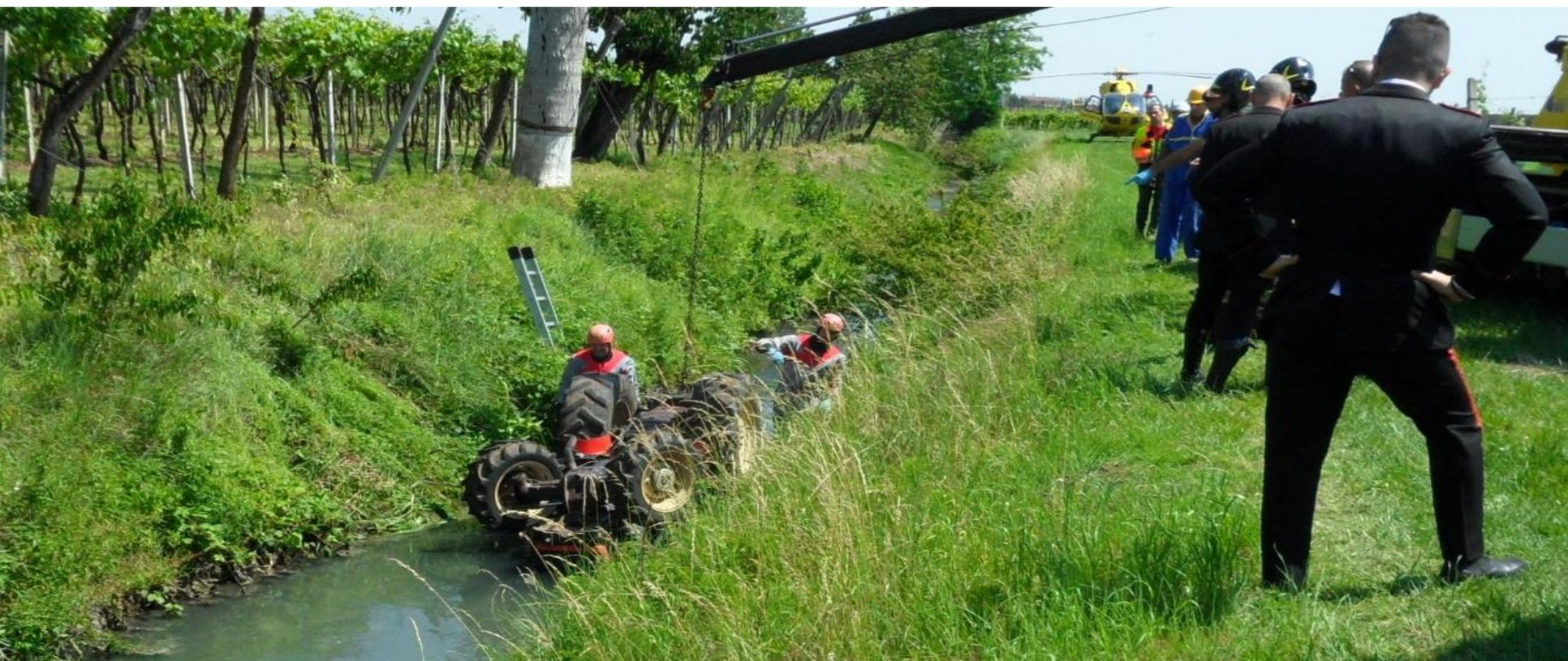
**Ribaltamento durante la manovra di inversione di marcia, si rovescia dentro al fossato adiacente rimanendo schiacciato. La trattrice era dotata di arco abbattibile e di cintura di ritenzione del conducente ma al momento dell'incidente l'arco era abbassato e la cintura non utilizzata dal lavoratore.**
