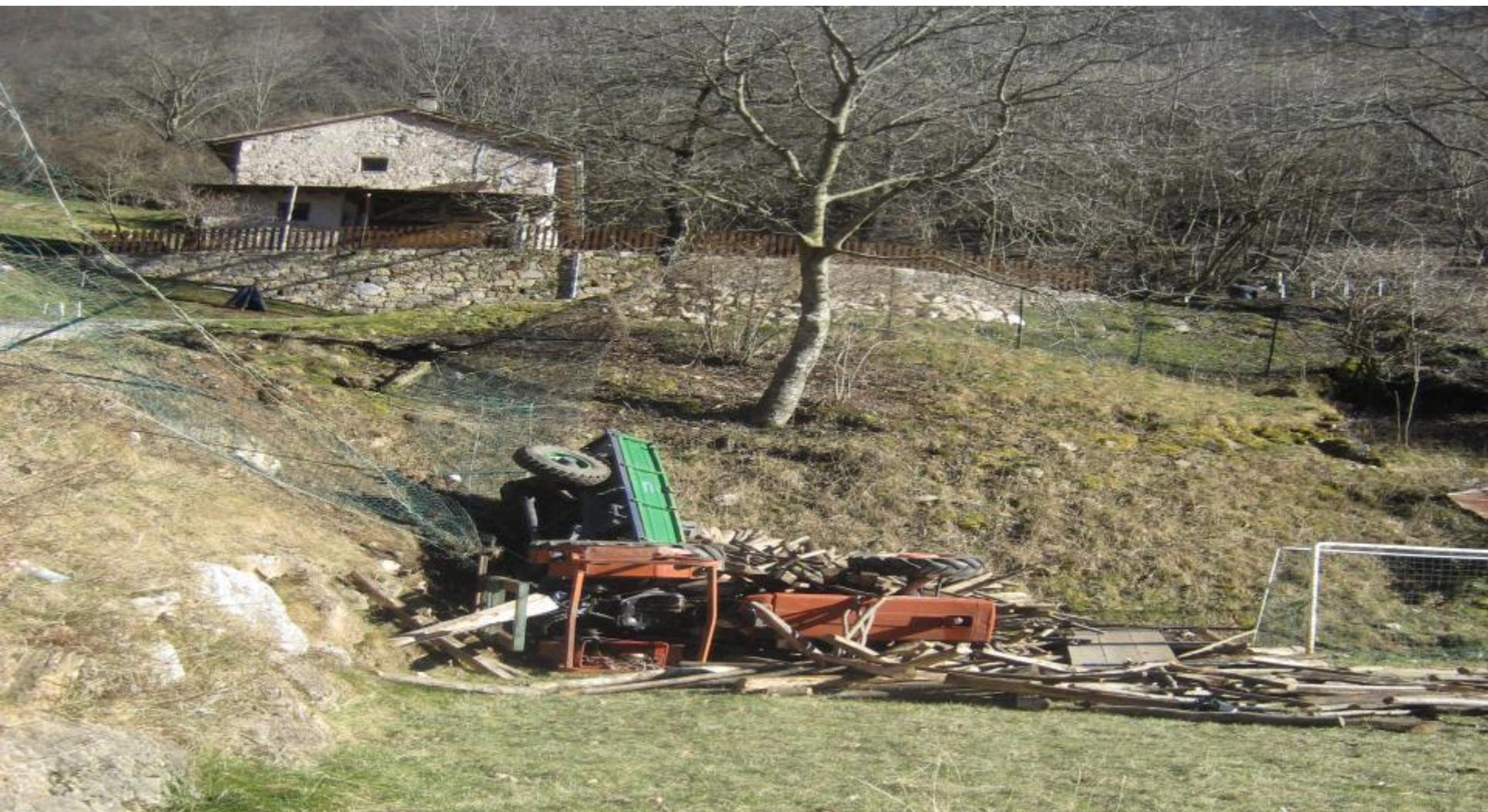
**Ribaltamento per uscita dal sentiero lungo il pendio per probabile carico eccessivo del rimorchio agricolo. Il telaio di protezione lo ha difeso dallo schiacciamento.**
