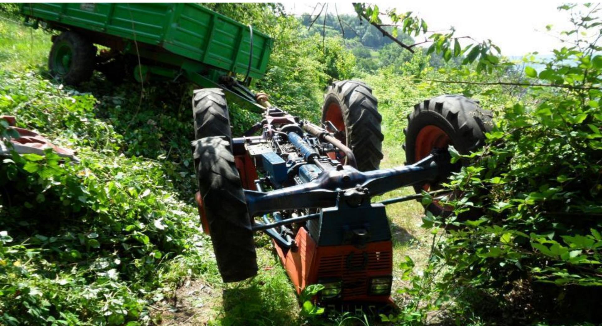
**Ribaltamento durante la raccolta delle ciliegie per la forte pendenza del terreno.
