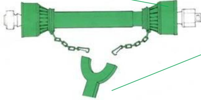
**Le estremità della protezione devono essere dotate di due catenelle, che agganciate rispettivamente alla trattrice e alla macchina operatrice, evitano la rotazione della protezione**
