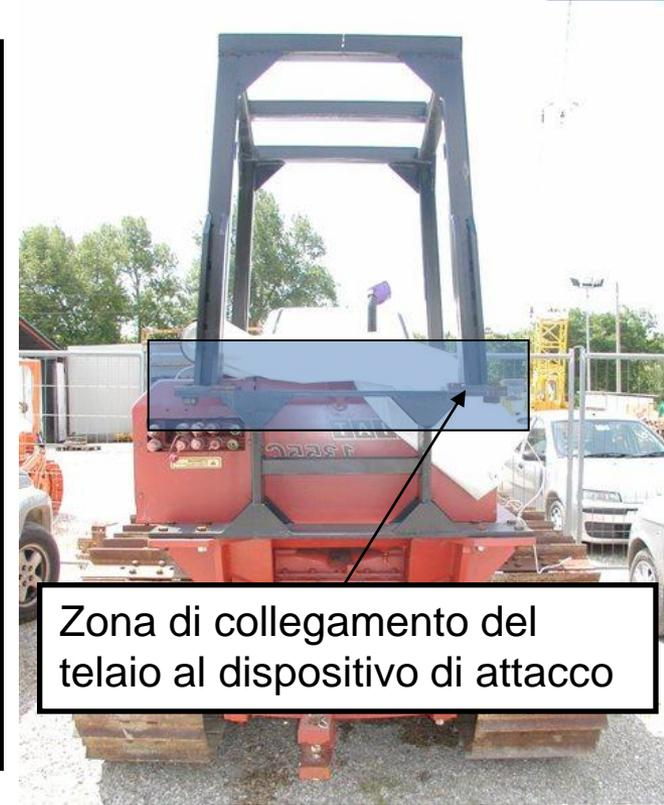
Zona di collegamento del telaio al dispositivo di attacco
