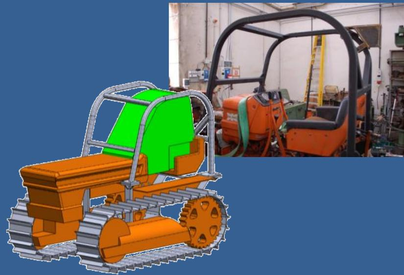
Il principale obiettivo è la riduzione della forza necessaria per la movimentazione della struttura di protezione, soprattutto durante la fase di riposizionamento in configurazione di sicurezza.
