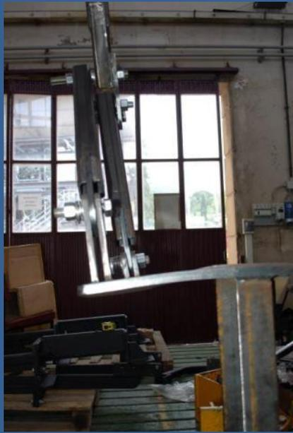
La struttura di protezione è stata preliminarmente verificata mediante metodo agli elementi finiti secondo quanto previsto dal codice 7 OCSE.
