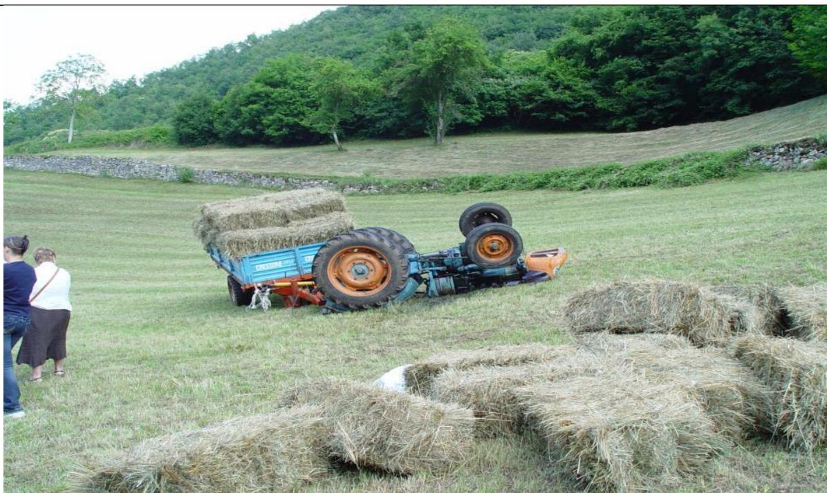
**Ribaltamento durante il trasporto di balle di fieno su un carro agricolo. E' probabile che la pendenza e l'eccessivo carico abbiano causato il ribaltamento. L'agricoltore è deceduto per schiacciamento sotto il**
