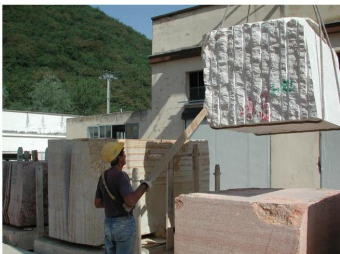
guidare se necessario il blocco, usando aste munite di gancio o pali per limitare le oscillazioni del blocco
