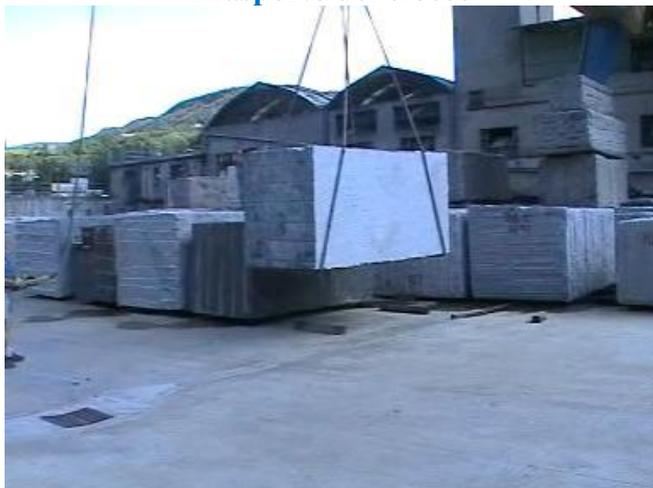
portare il blocco sulla verticale del corridoio di scorrimento fra le file di blocchi,
