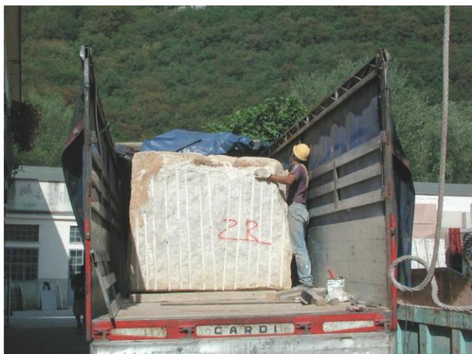
Controllare forma e integrità del blocco che non abbia spigoli lesionati, arrotondati o sporchi di terra nei quali casi è necessario, da posizione stabile e sicura, romperli e/o pulirli con mazza o piccone onde evitare che le corde in trazione si sfilino o si rompano e per garantire una presa sicura del blocco.
