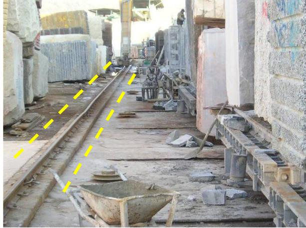
E' necessario segnalare i camminamenti sia all'interno che all'esterno della gambe della gru in quanto non devono essere utilizzate come zone di deposito
