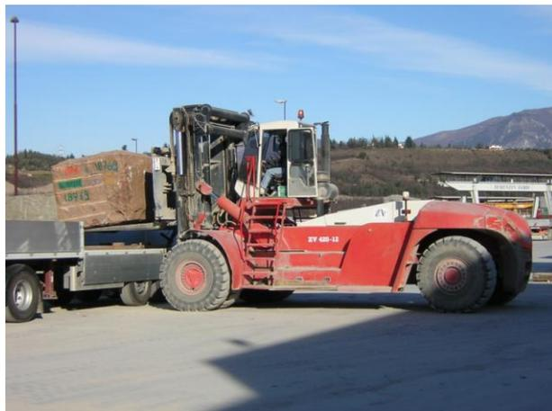
Nel definire i limiti degli spazi necessari per movimentare in sicurezza i materiali bisogna sempre tenere presente l'ingombro del camion (almeno 2,50 m.), le dimensioni del materiale da movimentare, ed il mezzo che si utilizza per le operazioni di carico/scarico.
