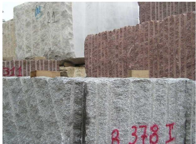
E' buona norma che gli strati dei blocchi squadri non superino mai due blocchi sovrapposti ed eccezionalmente tre, con la limitazione che la superficie superiore del secondo non superi i due metri di altezza. Ciò per limitare il più possibile l'uso di scale per l'imbracatura del terzo blocco.
