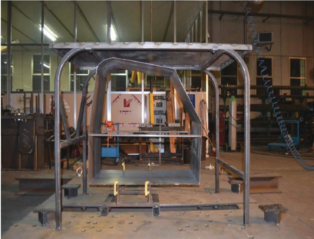
Indicazioni per la realizzazione e applicazione di strutture FOPS alle strutture di protezione a quattro montanti previste dalla linea guida Inail. Indicazioni per l'uso forestale del trattore.
