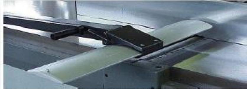
La norma UNI EN 859/99 prevede che l'unica protezione efficace per l'uso sicuro della macchina, sia quella denominata "riparo a ponte" (fanno eccezione le pialle piccole con spessore di piallatura fino a 100 mm, per le quali possono essere utilizzate le altre protezioni).
