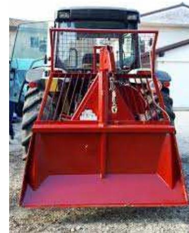
Il concentramento a strascico con verricello, detto anche strascico indiretto perché la macchina rimane ferma, consiste nel trascinare il legname mediante una fune di acciaio di un verricello sul terreno del bosco, lungo le linee di massima pendenza. Si effettua su distanze massime di circa 100 m in salita, 50 m in piano e 30 m in leggera discesa.
