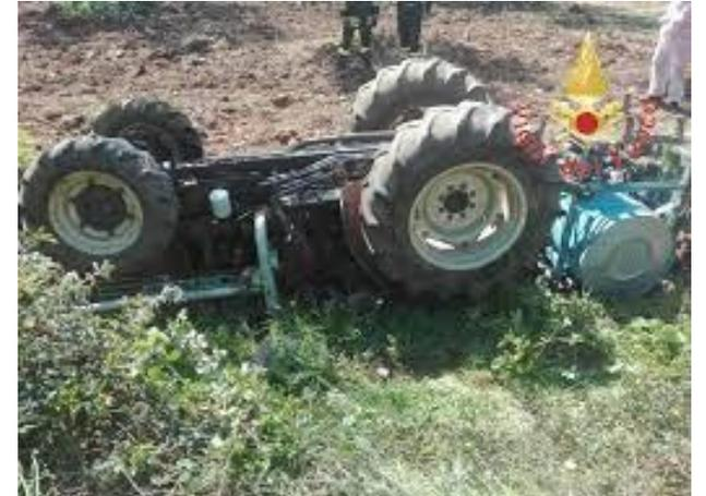
**IN ASSENZA DEL TELAIO DI PROTEZIONE NON E' GARANTITO IL VdS**
