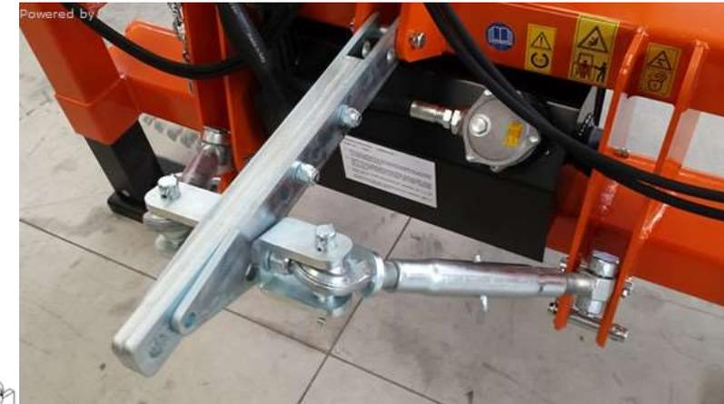
A – parti del dispositivo di bloccaggio di sicurezza
