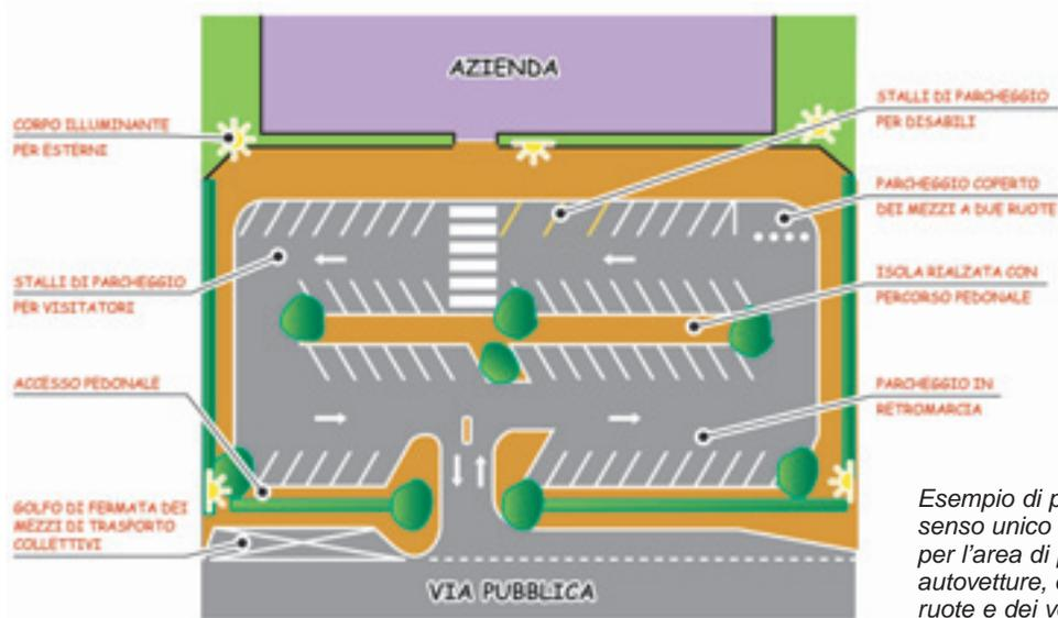
*Esempio di parcheggio con senso unico e senso rotatorio per l'area di parcheggio delle autovetture, dei mezzi a due ruote e dei veicoli leggeri*
