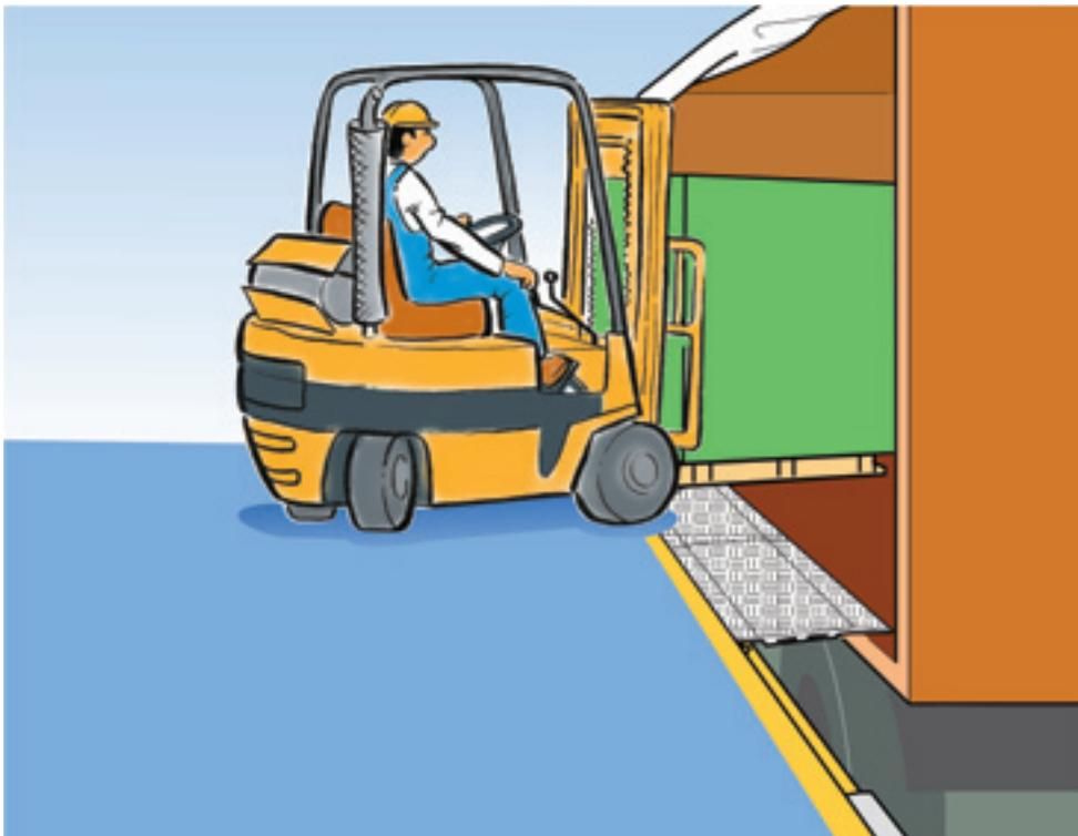
*Passerelle di carico inserite in un profilo di guida saldato alla cornice di protezione della banchina, accoppiate per permettere di eseguire le operazioni di trasbordo sulla larghezza totale dell'apertura*
