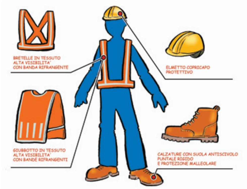
*Esempio di indumenti particolari rifrangenti da indossare in ore notturne o in altri casi di scarsa visibilità (cintura con bretelle, manicotti e gambali)*
