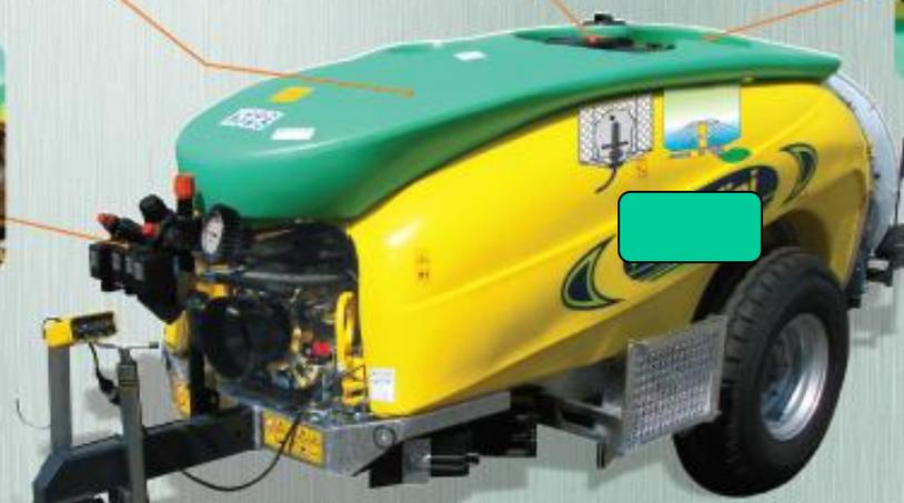
Atomizzatore a norma, certificato VS ENAMA, con cuffia di protezione cardano sulla pompa e aggancio per il supporto del cardano a riposo
