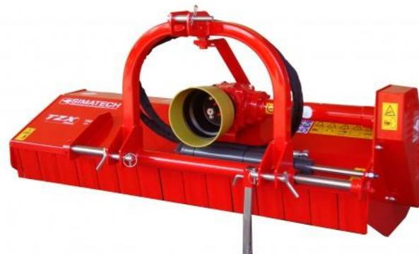
Protezione anteriore con barre distanziatrici e bande per la proiezione del materiale
