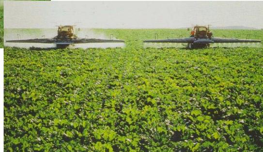
Per una barra irroratrice, l'ugello antideriva è già una soluzione ottimale, eventualmente in abbinamento alla manica d'aria
