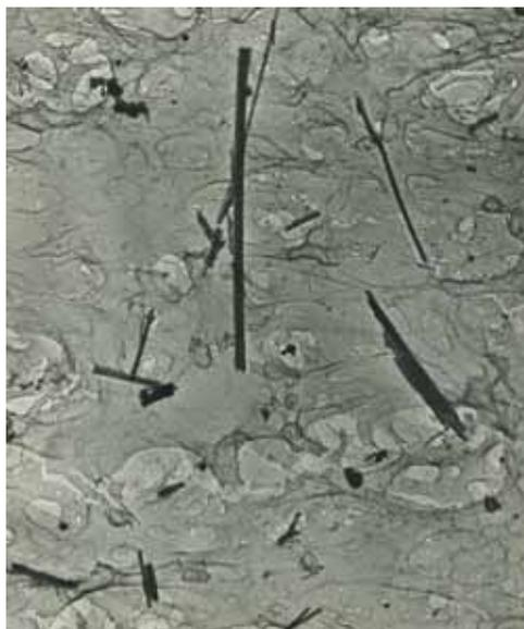
Figura 10. - Un campione di talco contaminato da fibre di amianto tremolite osservato in microscopia elettronica a scansione.
