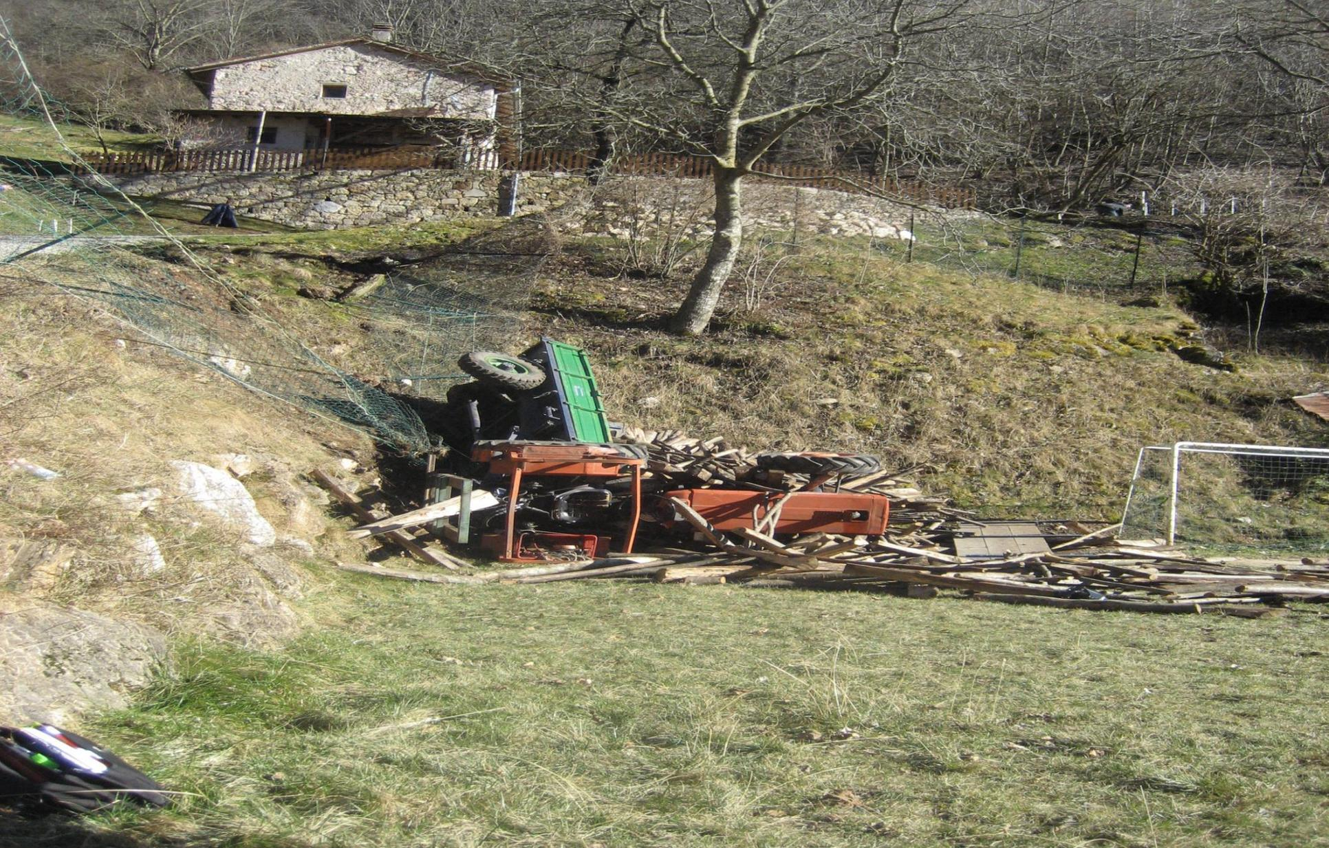
**Ribaltamento per uscita dal sentiero lungo il pendio per probabile carico eccessivo del rimorchio agricolo. Il telaio di protezione lo ha difeso dallo schiacciamento.**
