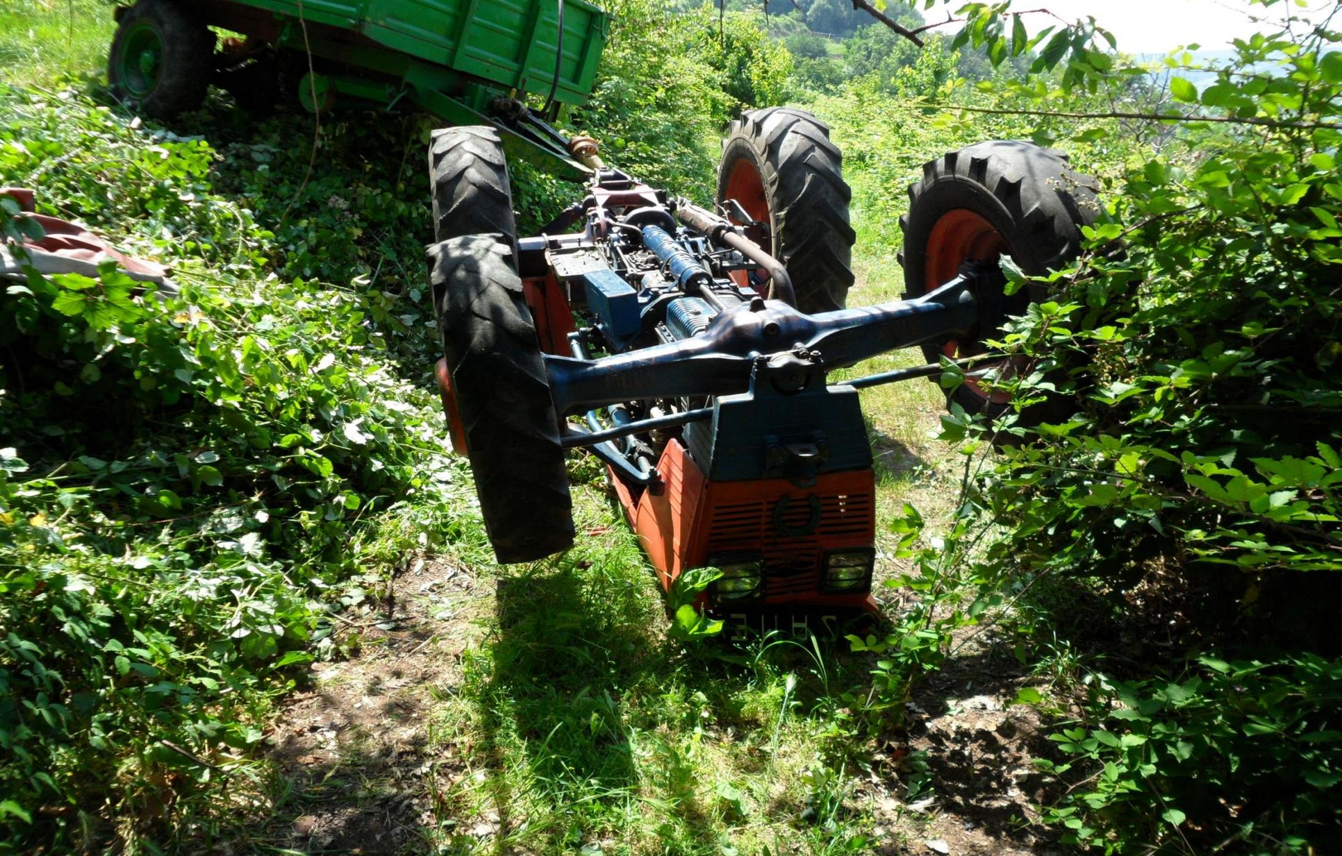
**Ribaltamento durante la raccolta delle ciliegie per la forte pendenza del terreno. E' rimasto schiacciato sotto il trattore per la mancanza della protezione del posto di guida**
