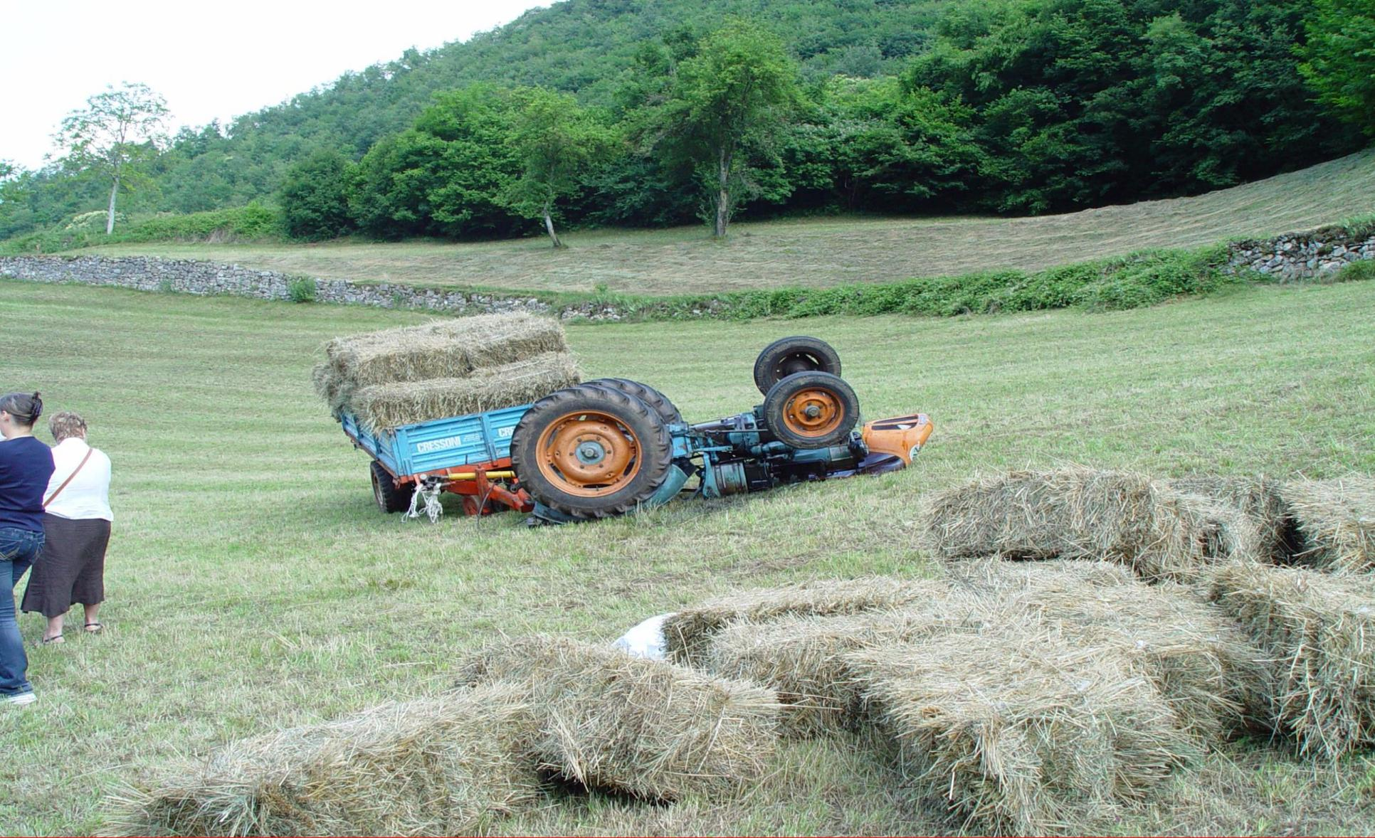
**Ribaltamento durante il trasporto di balle di fieno su un carro agricolo. E' probabile che la pendenza e l'eccessivo carico abbiano causato il ribaltamento. L'agricoltore è deceduto per schiacciamento sotto il trattore per mancanza di protezione del posto di guida.**
