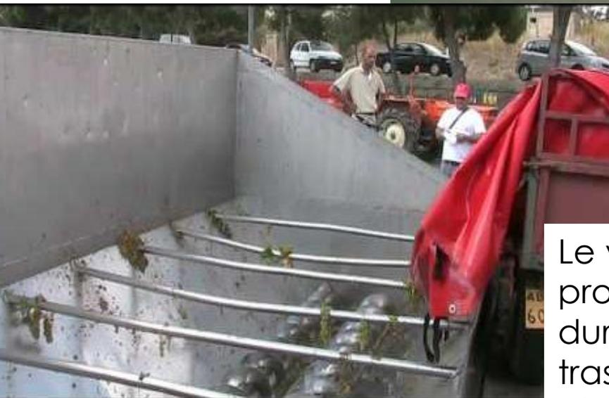
Le vasche di conferimento devono essere protette contro la caduta accidentale, durante il funzionamento della **coclea** di trasporto con **barriere e parapetti** e dotate di dispositivi di sicurezza (es. fotocellule).
