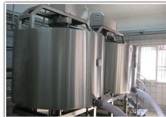
**scambiatore termico** (opzionale), che ha lo scopo di effettuare il trattamento termico e/o la refrigerazione del latte;
