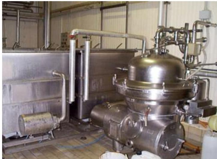
**Caldaia a doppio fondo:** è essenzialmente costituita da una tazza in acciaio inossidabile, dotata di una camicia per il passaggio del vapore utilizzato per il riscaldamento del siero.
