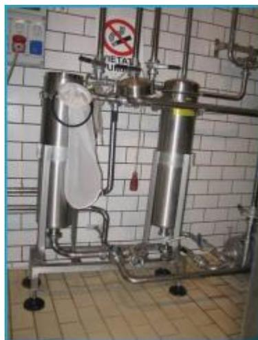
**misuratore volumetrico** del latte di tipo meccanico o elettromagnetico
