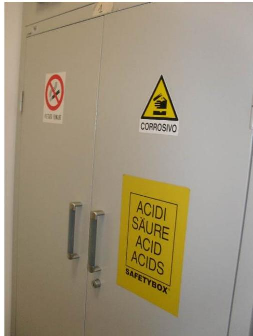
**Ogni armadio specifico per categorie di prodotti e' dotato di tubo aspiratore ed e' rigorosamente chiuso a chiave.**
