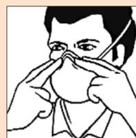
4. Posizionare le dita di entrambe le mani sulla parte superiore dello stringinaso. Premere lo stringinaso e modellarlo muovendosi verso le sue estremità. Evitare di modellare lo stringinaso con una sola mano poiché può causare una diminuzione della protezione respiratoria.
