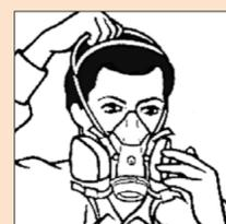
1. Posizionare il respiratore davanti alla bocca e al naso. Tirare la bardatura sopra la testa. Se necessario riposizionare il respiratore o la bardatura superiore fino ad ottenere una confortevole tenuta.
