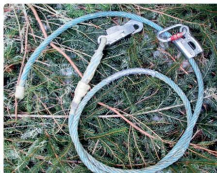
...esempio di “Longe” (corda in acciaio semirigida) utilizzata per la salita su piante
