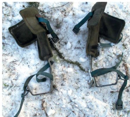
...esempio di ramponi utilizzati nella salita su piante
