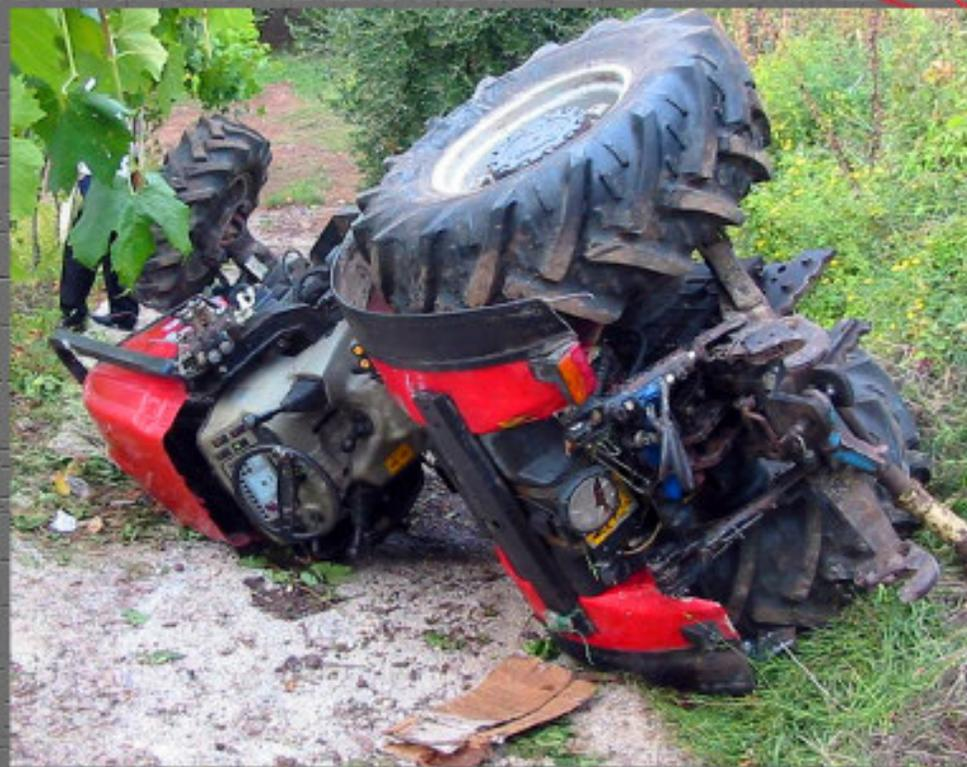
I trattori DEVONO POSSEDERE un sistema di protezione del posto di guida e la cintura di sicurezza per il conducente; come previsto dal Testo Unico sulla sicurezza (D.Lgs. 81/08) e dal Codice della Strada...
