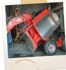
IL LAVORATORE DURANTE LE OPERAZIONI DI MANUTENZIONE NELL' APRIRE LE DUE PARTI LATERALI DELLA PALA LIVELLATRICE HA COLPITO UN COLLEGA DI PASSAGGIO
