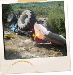
IL LAVORATORE mentre percorreva un'area boschiva con il trattore con agganciata una trincia stocchi, ha urtato un albero Il trattore impennandosi sbalzava a terra il guidatore che restava schiacciato dalla trincia stocchi.
